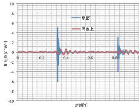
上述结果是利用加速度计测得的人在装置周围行走时的地面振动以及设置有BFD14M630的装置上的振动。
