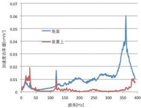
使用加速度计测量工厂地面振动与设置有BFD14M97H的装置上的振动的结果。
