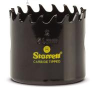
硬质合金开孔锯在嵌钉木、金属木材、钢筋混凝土以及玻璃纤维的切割上,能够提供一种具有成本效益的方法。这种孔锯特别适用于对切割面光滑度有高要求的情况,能够在切割传统木板条和石膏板时,保持切口平整。
