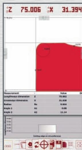
**3** EZstart最多可提供5个测量结果 (Z、X、半径、角1和角2)
