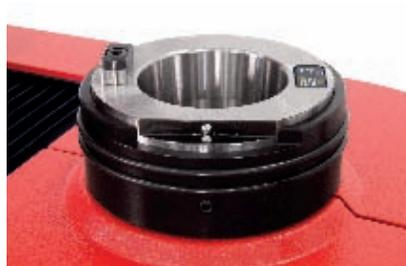
**SK50刀架主轴**具有极高的同心度和集成校准刃口。
