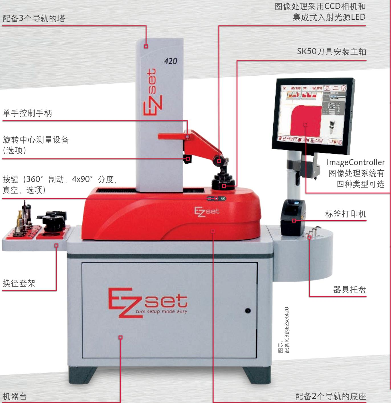
EZset刀具预调设备采用ICbasic、IC1、IC2和IC3等四种图像处理系统，适用于各种测量范围。
