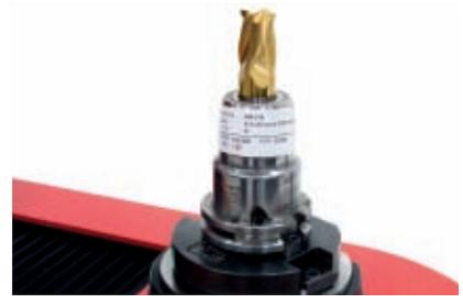
**标签打印：**数秒钟内精确可靠地提供五个测量结果，包括刀具切削刃长度、直径、半径、角1和角2。
