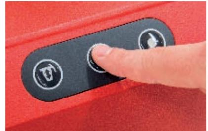
**薄膜键盘**以气动方式运行4x90°分度和SK50刀架主轴制动器，还可选配真空夹紧功能。
